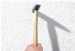
**Klopfetest:** Suchen Sie nach Hohlräumen, indem Sie in regelmäßigen Abständen vorsichtig die Fassade mit dem Hammer abklopfen. Hohlräume müssen vollständig geöffnet, gesäubert und neu verputzt werden.
