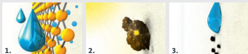
So bleibt die Fassade lange sauber: **1.** Regen perlt ab, trotzdem kann die Fassade „atmen“. **2.** Schmutzpartikel werden durch Sonne fotokatalytisch zersetzt. **3.** Zersetzte Partikel werden einfach „abgewaschen“.
