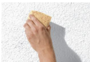
**Saugfähigkeitstest:** Tragen Sie mit einem nassen Schwamm Wasser auf die Fassade auf. Wenn das Wasser schnell einzieht, sollte die Oberfläche vor dem Anstrich unbedingt grundiert werden.
