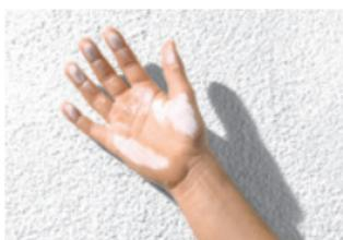
Abriebtest: Reiben Sie mit der Handinnenfläche über die Fassade. Bildet sich ein weißer, mehltiger Abrieb, benötigt die Fassade eine erneute gründliche Reinigung und anschließend eine Grundierung.
