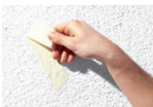
Tragfähigkeitstest: Kleben Sie ein Stück Klebeband auf die Fassade. Bleiben beim ruckartigen Lösen des Klebebands Teile des Altanstrichs kleben, so muss der Altanstrich in diesen Bereichen entfernt werden.
